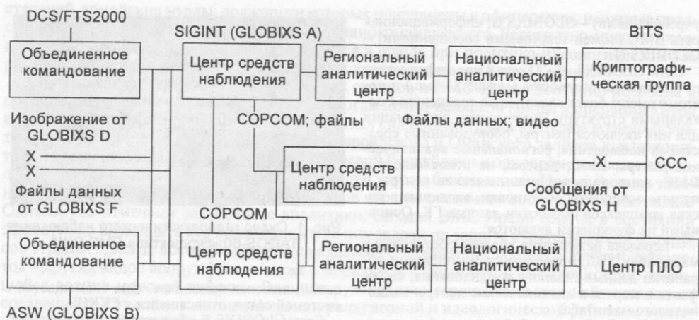
Рис. 2. Схема взаимодействия сетей обмена информацией GLOBIXS A и B: DCS (Defense Communication System) – система связи министерства обороны США, FTS2000 (Federal Telecommunications System) – федеральная телекоммуникационная система США, BITS (Base Information Transfer System) – базовая система передачи информации министерства обороны, служащая для связи кораблей в базе и береговых центров, CCC (Commander-In-Chief Command Complex) – комплекс обработки данных главного командования, COPCOM (Copernic Common) – сообщения единого формата программы «Коперник»
