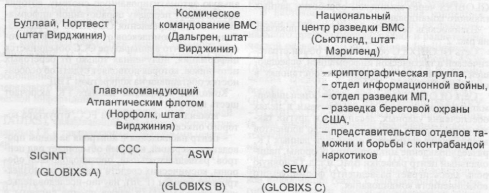
Рис. 3. Схема взаимодействия комплекса обработки данных главнокомандующего Атлантическим флотом с сетями обмена данными GLOBIXS A, B и C
